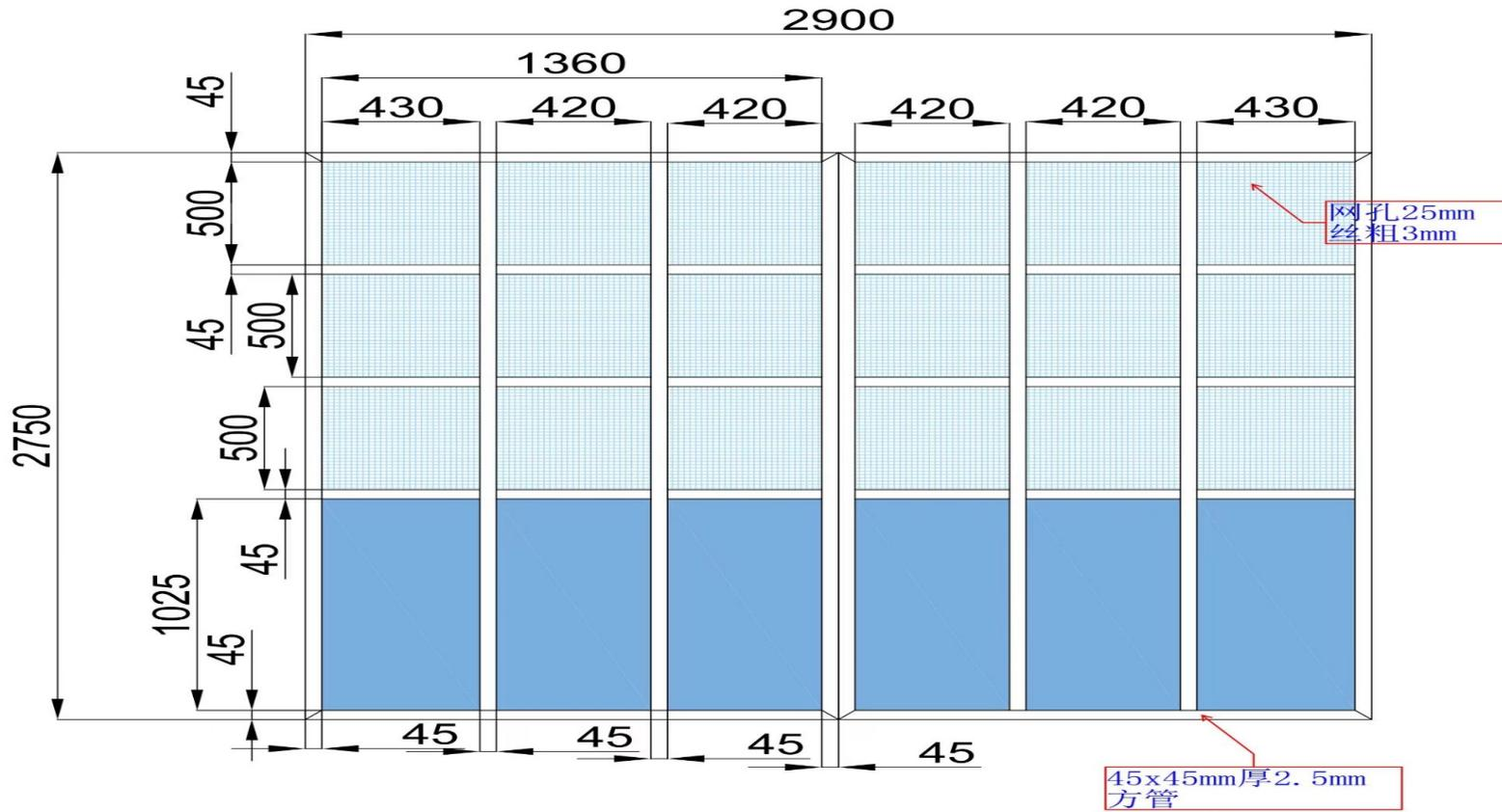
注：单扇门的四周外框用 2.5mm 厚不锈钢方管，内框用 1.2mm 厚不锈钢方管；上部网孔 25\*25MM，网丝直径 3mm。
